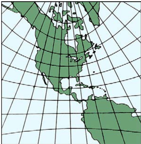
Figure 416b. An oblique gnomonic map with point of tangency at latitude 30°N, longitude 90°W.
